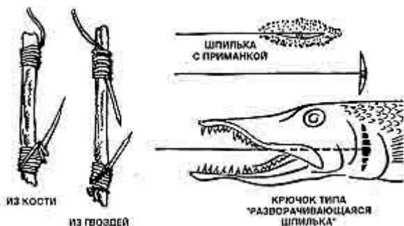
Рис. 6. Импровизированные приспособления для рыбной ловли
